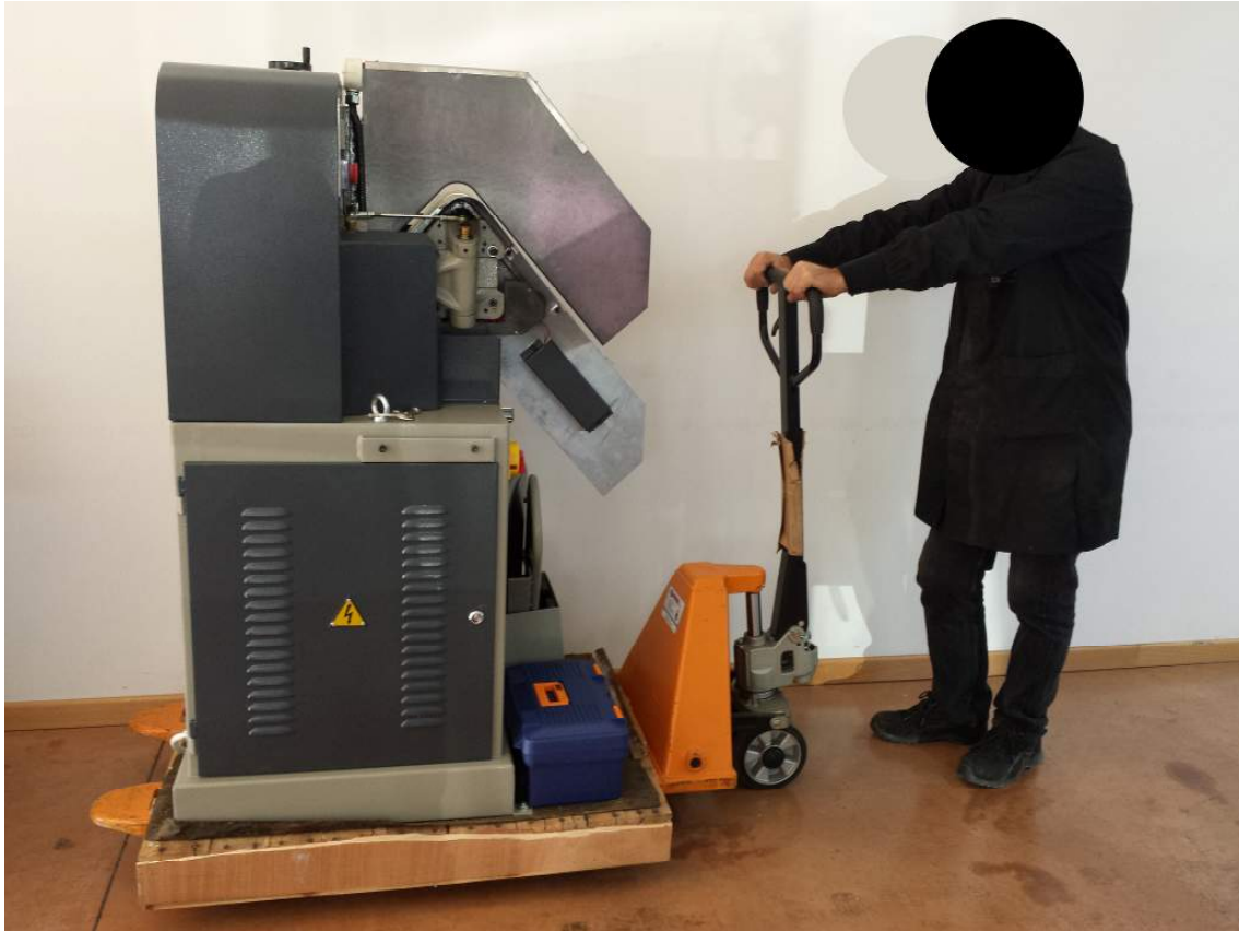
Figura 16 - Movimentazione con carrello manuale
