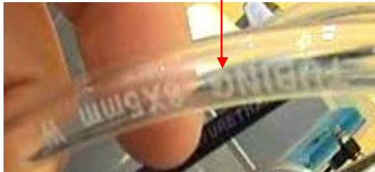
Figura 21 - Sostituzione dei tubi della colla
