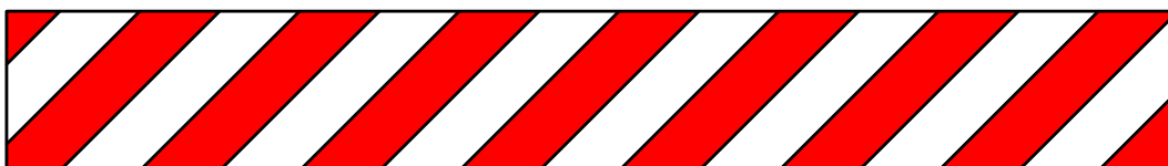
Figura 2 Esempio di colorazione per segnalazione di una zona con divieto di accesso ai non autorizzati
