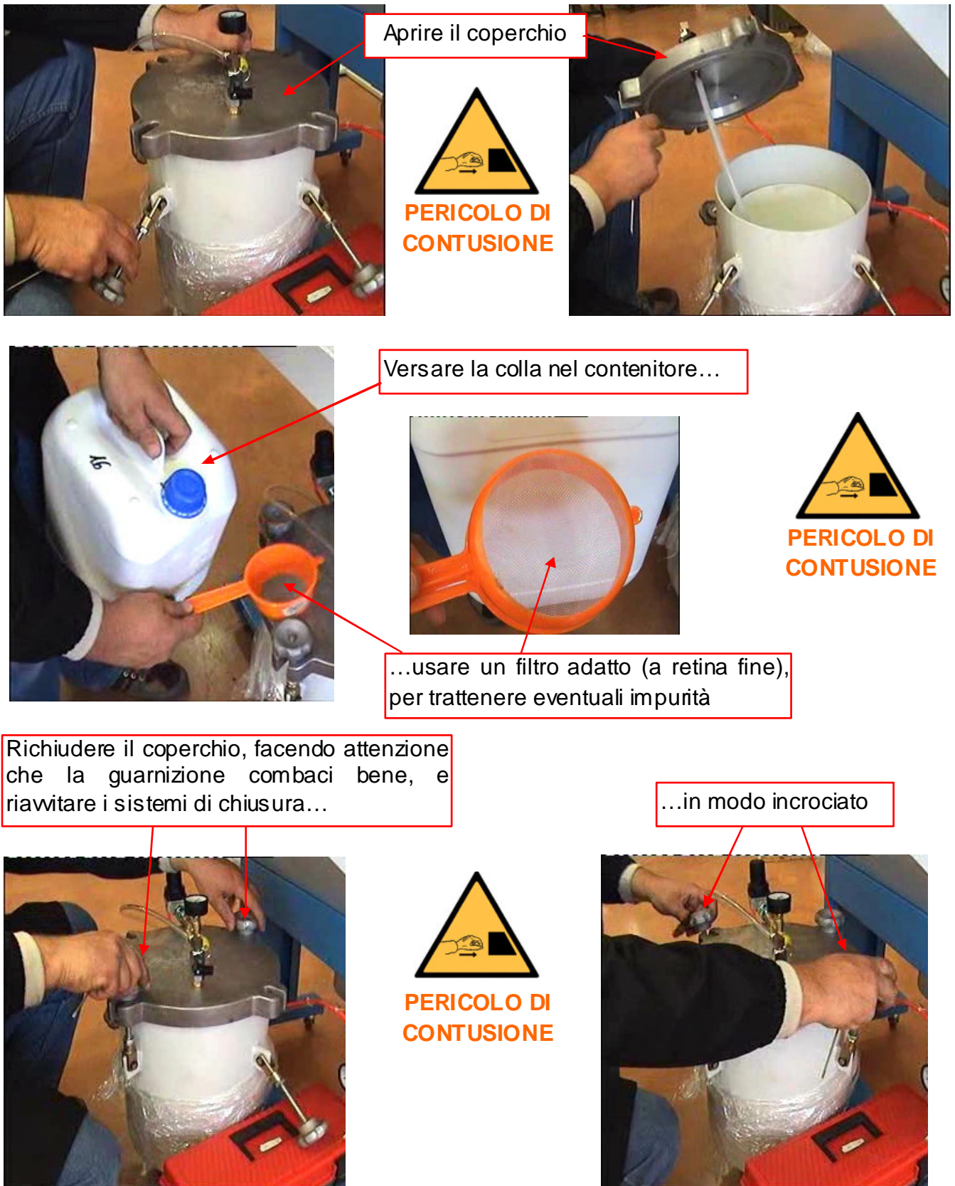
Figura 19 - Riempimento del contenitore della colla
